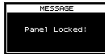
Wenn Sie den [SHIFT]-Taster gedrückt halten und den [SPEAKER ON]-Taster drücken, wird die Sperre wieder aufgehoben.
